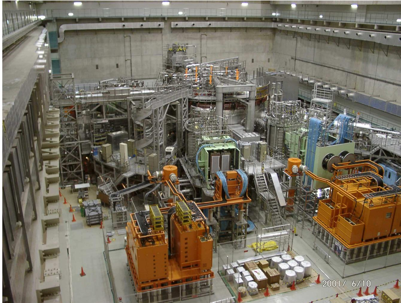
Пучки нейтралов мощностью **16 MW** (**180 keV**) используются в стеллараторе LHD для нагрева плазмы
